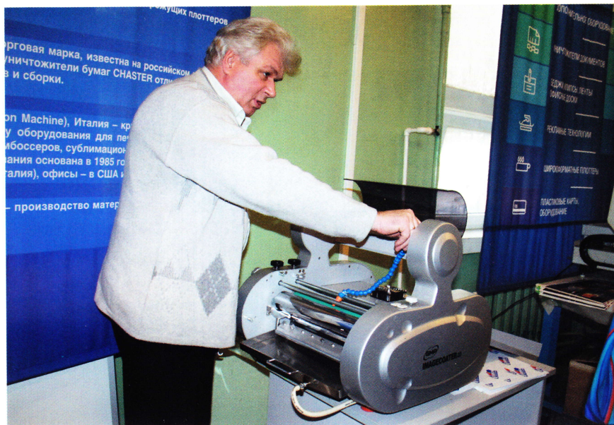
Демонстрация настольной УФ-лакировальной машины GMP Image Coater
